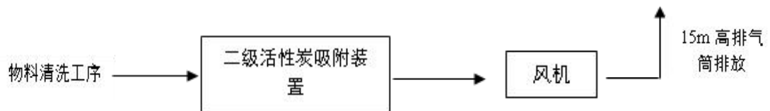
图 4-1 废气处理流程示意图
