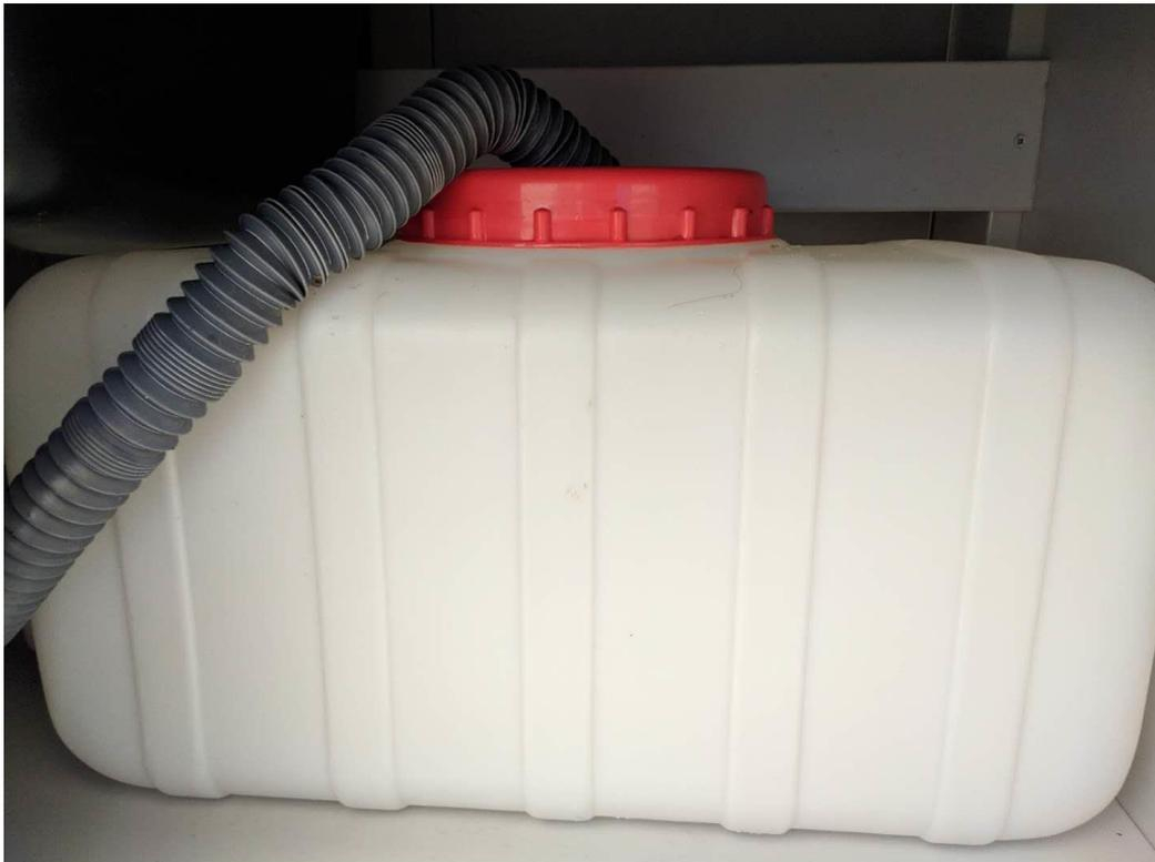
实验室清洗废液收集装置
