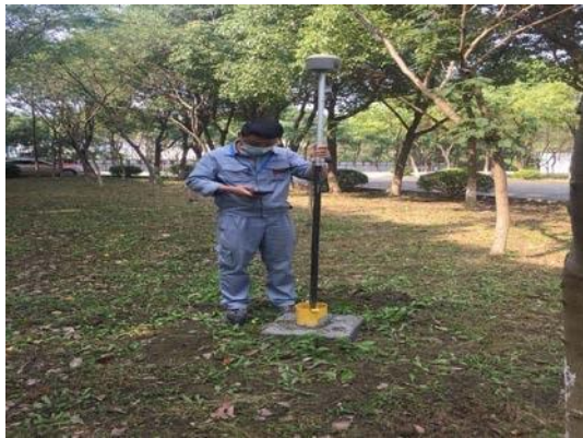
RTK 管口高程测量
