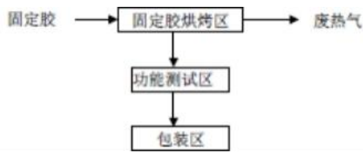
图2 集成电路IC测试生产工艺流程
